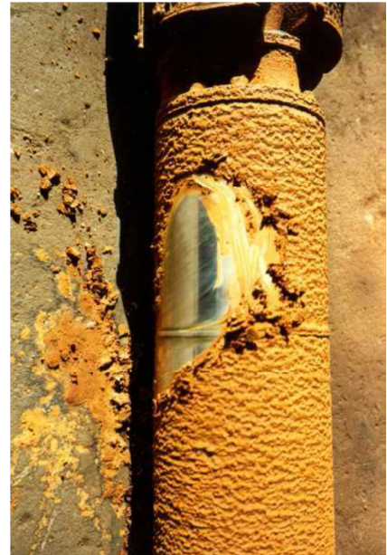
Afbeelding 1 Voorbeeld van zware ijzerafzetting op de motor.
